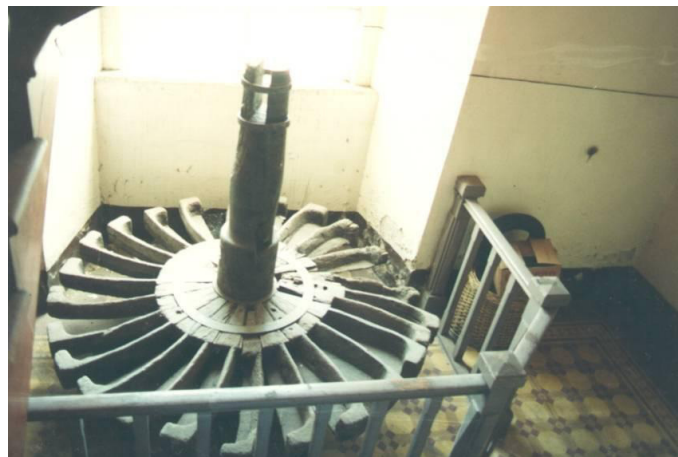
Figura 9. Turbina Hidráulica original en "El Hércules" tipo Giffard (ca. 1850) Querétaro. Foto de Daniel Valencia Cruz.
