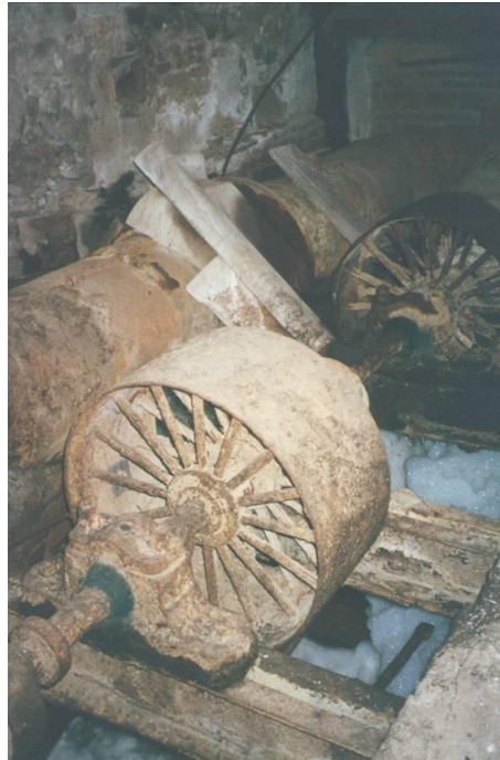
Figura 8. Rueda Hidráulica de Fuerza Motriz original. "Bellavista" (ca. 1843) Tepic. Foto de Humberto Morales 22 .
