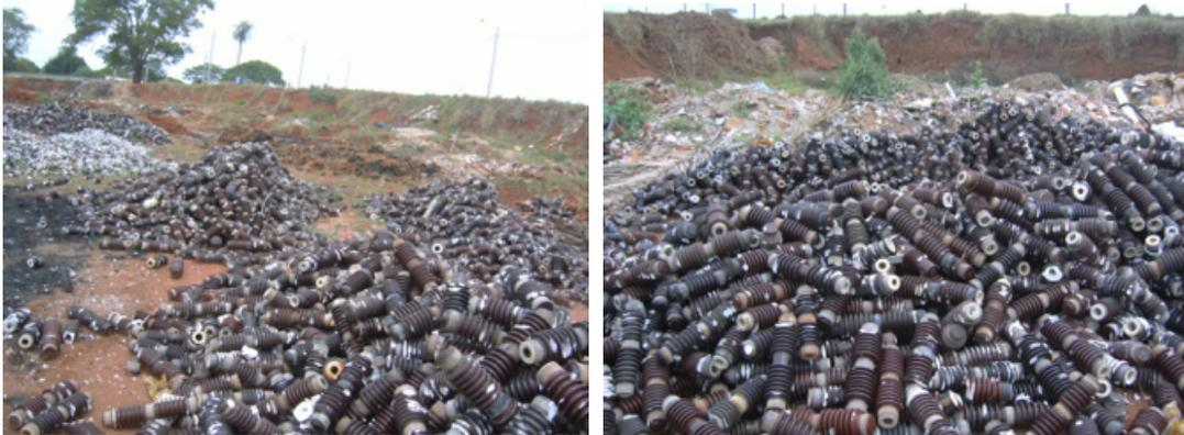
Figura 1. Isoladores de porcelana descartados em terrenos baldios. Fonte: CAMPOS, 2011.
