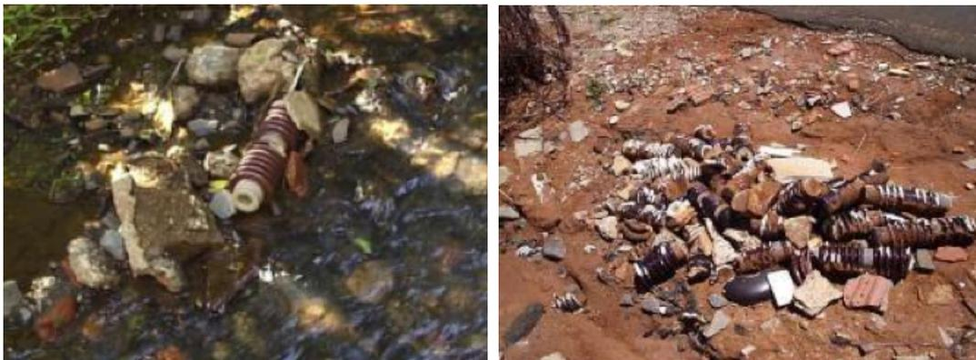
Figura 2. Descarte dos isoladores de porcelana em estradas rurais (à esquerda), e nos rios (à direita). Fonte: CAMPOS, 2009.
