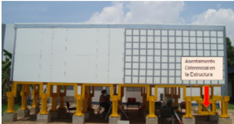
**Figura 5.** Prueba experimental ante asentamientos diferenciales en estructura a escala real. (Archivo personal).
