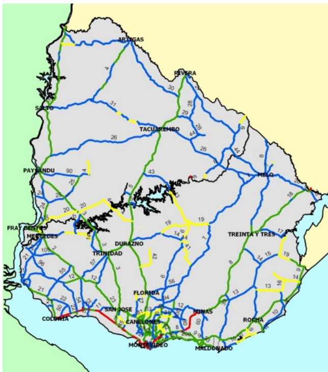
Figura 1. El presente mapa de rutas del Uruguay denota el trazado existente de la Ruta Nº4 Andresito. En amarillo se indica el trazado con material suelto. Los colores celeste y verde indican el tramo pavimentado en buen estado y en regular estado respectivamente.
