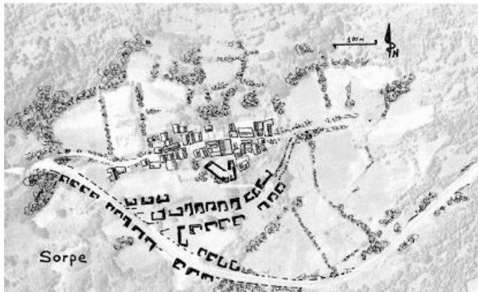
Figura 2. La población de Sorpe (Pirineo Catalán) nos ofrece otro ejemplo de gran interés, ya que se sitúa sobre un rellano bastante extenso que, según el planeamiento previsto, se verá ocupado por desarrollos residenciales a base de bloques de unas cuatro o cinco plantas). Como se aprecia, el patrón tradicional del pueblo es una suburbana que permite una orientación dominante al SE, muy adecuada en un clima tan frío, y que deja libre la mayor parte del espacio cultivable, condición necesaria para la subsistencia.
