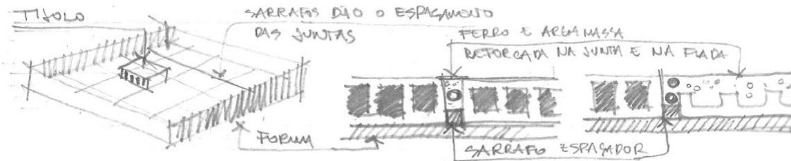
Figura 10. Preparação das formas de madeira para execução das placas de cerâmica armada. Fonte: Marques, 1984.
