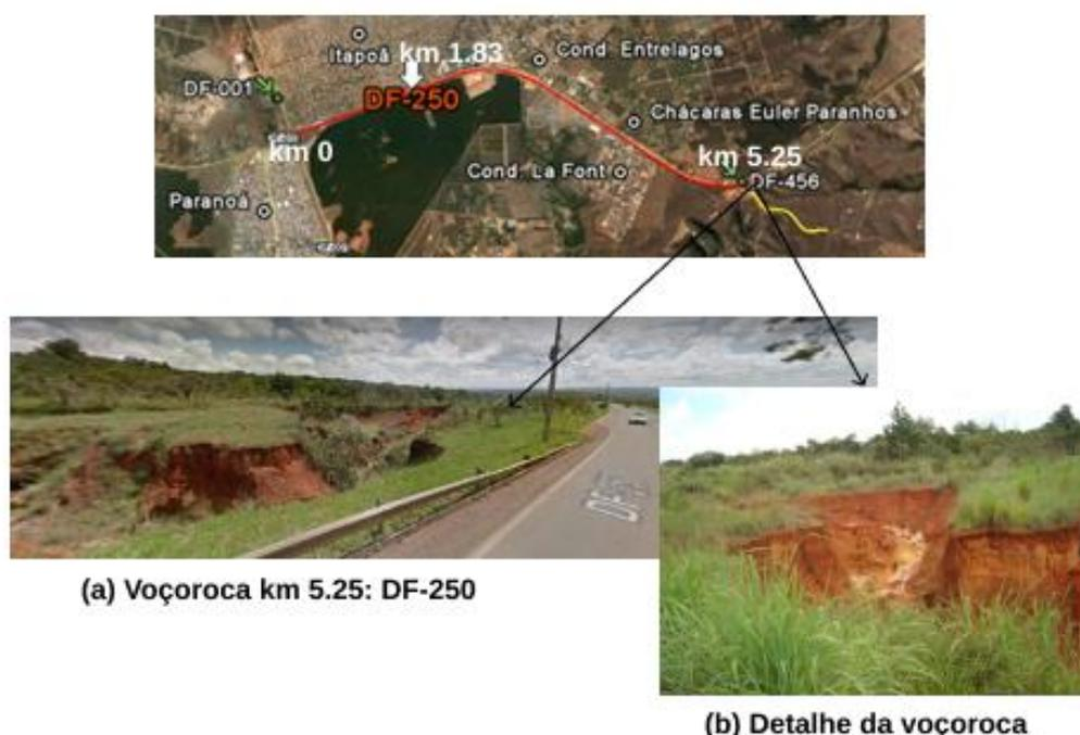
**Figura 1.** Localização do processo erosivo ao longo da faixa de domínio (margem norte) da DF-250.
