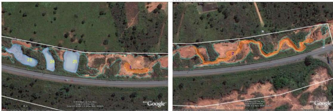
Figura 9. Processo erosivo na faixa de domínio (margem norte) da DF-250, km 4,61 – km 5,25. Fonte: DER-DF, 2018.
