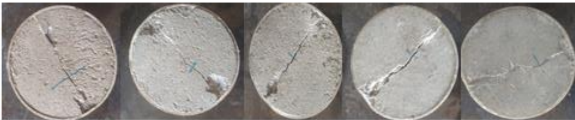
Figura 5. Evolução da cicatrização de fissuras até a 8ª rodada de tratamento. Fonte: Adaptado de Kulkarni et al. (2020).
