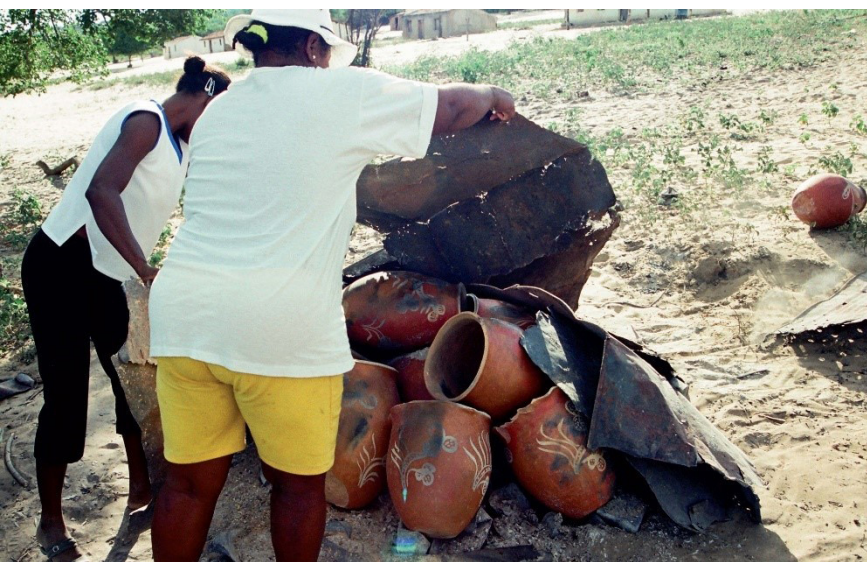
FIG. 10. Artesãs cobrem a cerâmica com chapas de flandres para obter uma distribuição igualitária do fogo na queima das peças.
