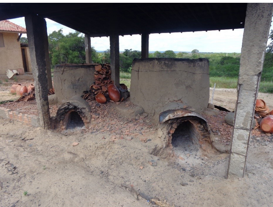
FIG. 11. “Fornos descobertos” para queima de cerâmica no povoado de Passagem, zona rural de Barra (Bahia). Fonte: arquivo da autora.
