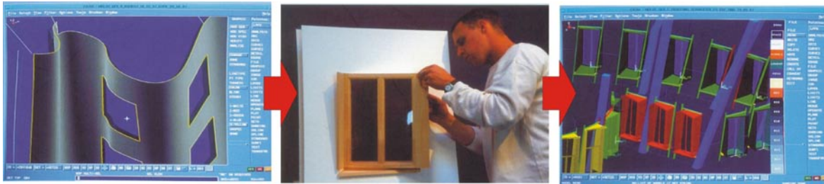
FIGURA 2: Estudo de um elemento de fachada. Projeto Der Neue Zollhof, Dusseldorf, Alemanha, 2000, Frank O. Gehry Fonte: Schmal (2001, pp. 99)
