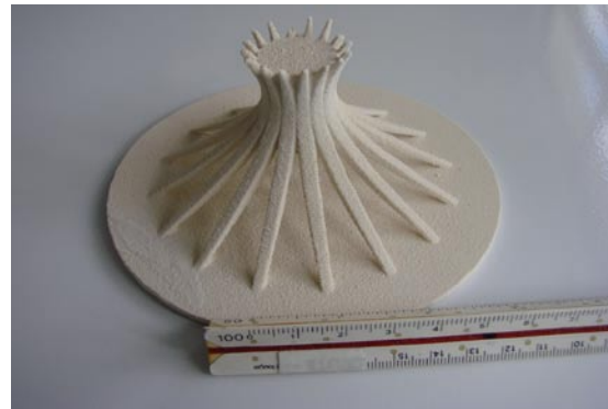
Peça prototipada em gesso – ZCorp 310 Alunos: Izabella Maciel e Renan Torricelli Foto: Regiane Pupo
