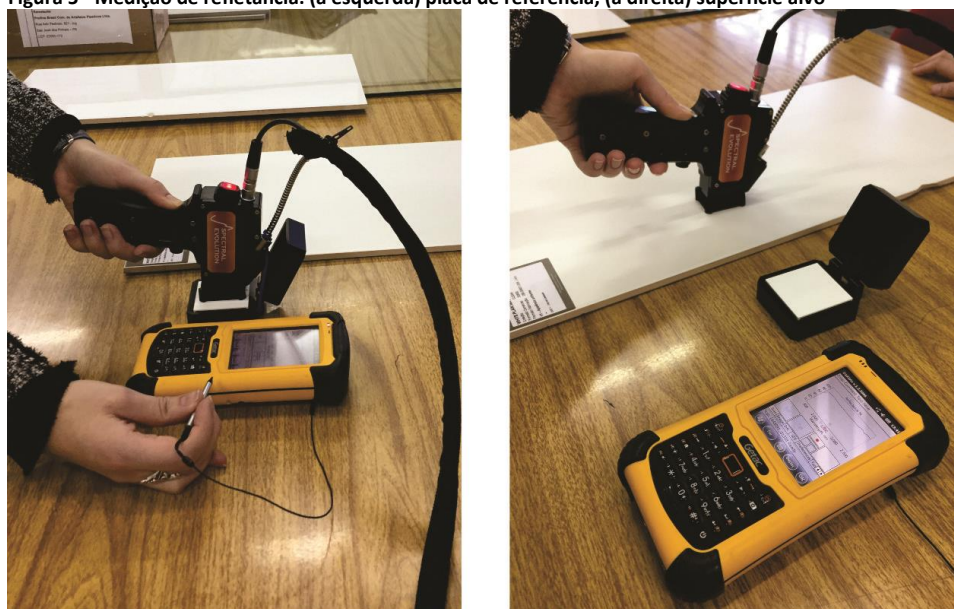
Figura 5 - Medição de refletância: (a esquerda) placa de referência, (a direita) superfície alvo
