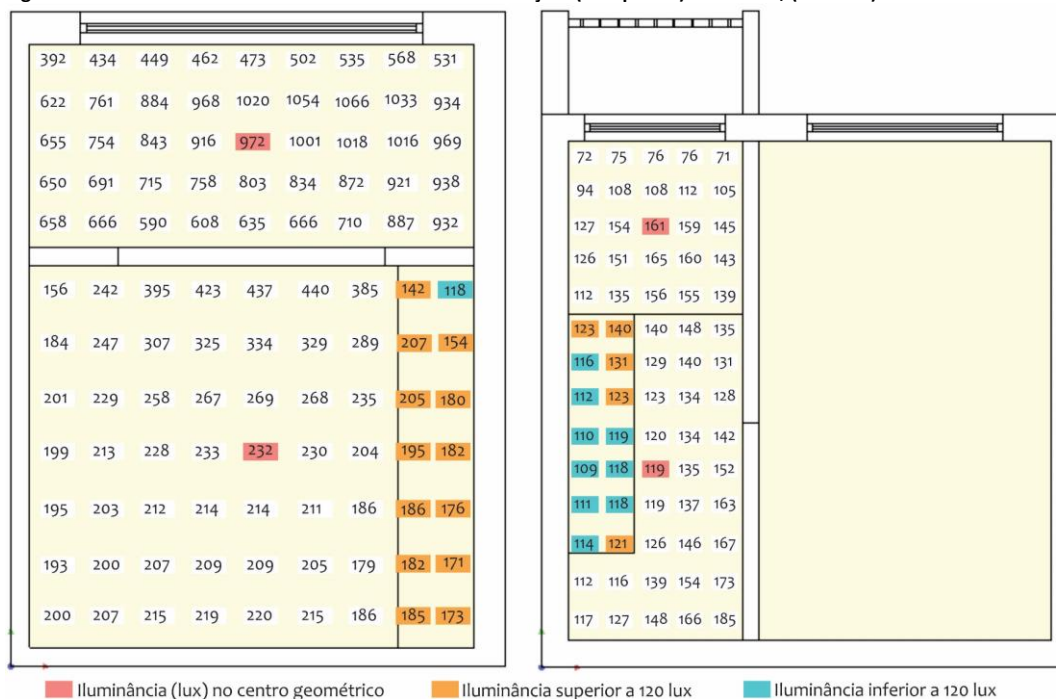
Figura 9 – Valores de iluminância obtidos na malha de medição: (a esquerda) modelo I1, (a direita) modelo I4
