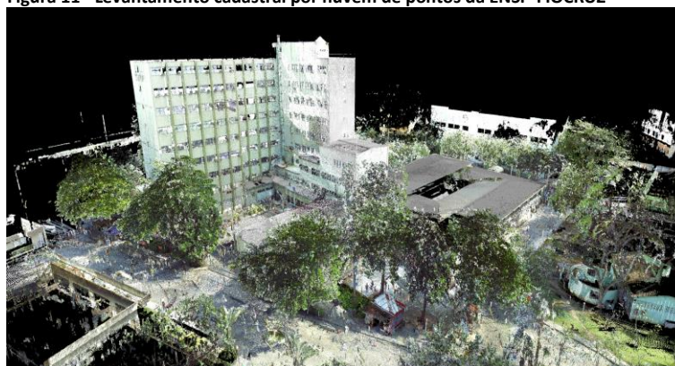
Figura 11 - Levantamento cadastral por nuvem de pontos da ENSP-FIOCRUZ
