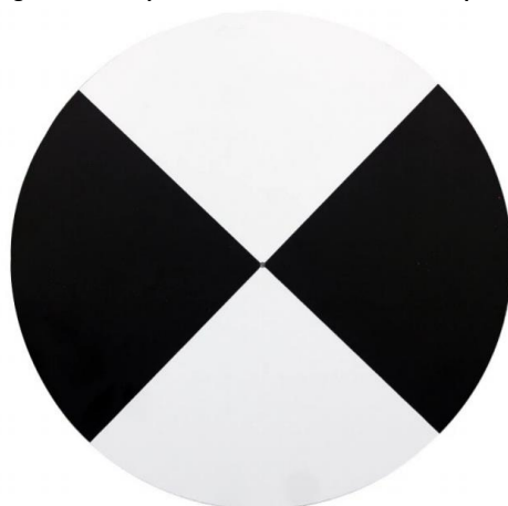
Figura 3 – Alvo preto e branco circular utilizado para o georreferenciamento e avaliação posicional
