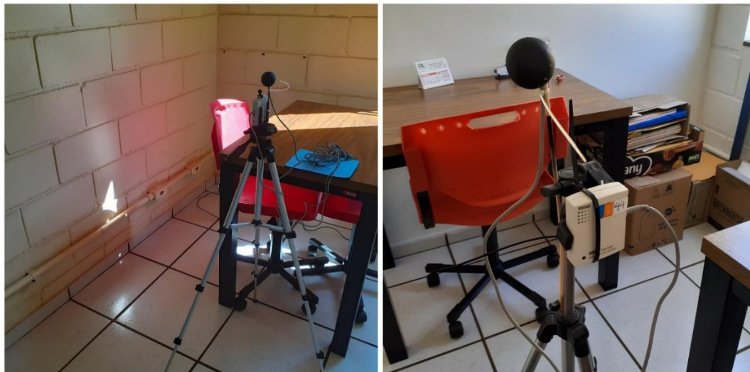
Figura 7 - Termohigrômetro do monitoramento microclimático interno
