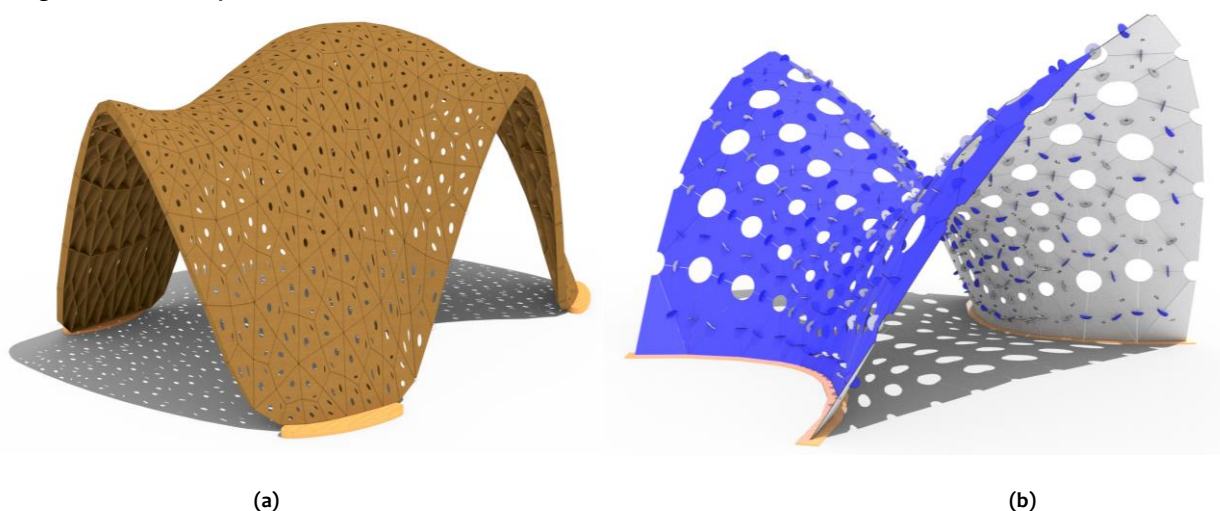
Figura 6 – Primeiros modelos de teste das duas tipologias estudadas: (a) Modelo de caixas em papelão; (b) Modelo de peças em chapas triangulares conectadas por discos
