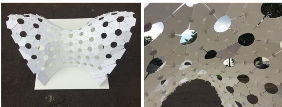
Figura 9 – Imagens da maquete montada do parabolóide hiperbólico, formado por peças triangulares impressas em PLA
