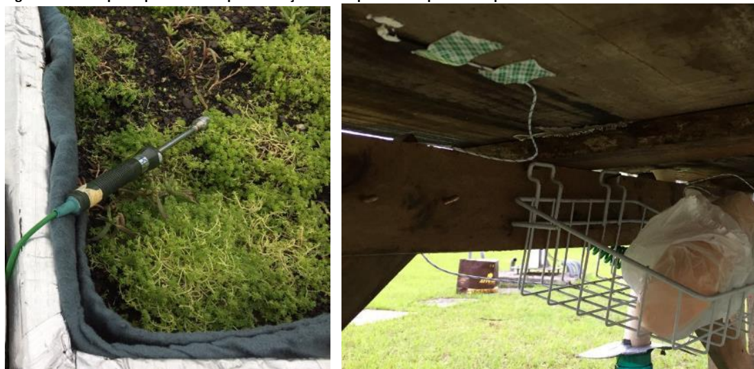
Figura 7 – Termopares posicionados para medição da temperatura superficial superior e inferior
