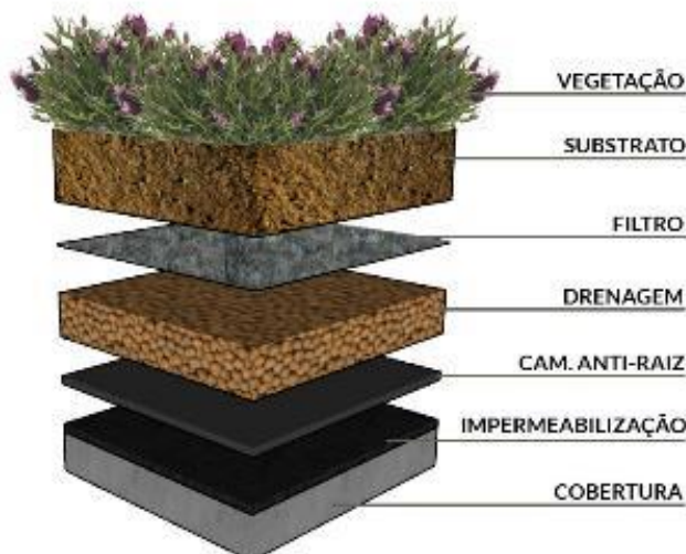
Figura 1 - Componentes do telhado verde
