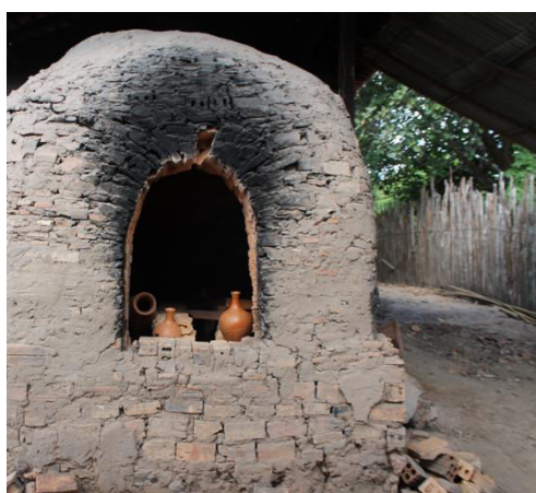
Figura 16. Forno de queima cerâmica, com objetos já queimados em seu interior. Foto: Arkley Bandeira (2017).
