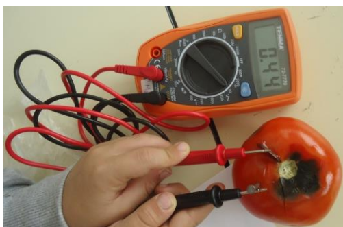
Figura 13 – Medição da d.p. e da intensidade de corrente de pilhas biológicas. Cálculo da potência máxima fornecida.
